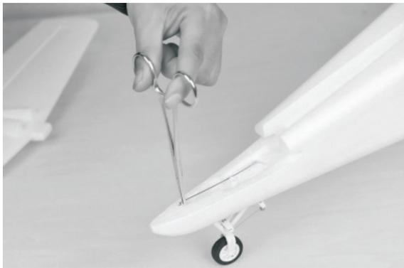
Ziehen Sie das Höhenleitwerksanlenkung ein kleines bisschen aus dem Rumpf und führen Sie dann die „Z - Biegung“ der Anlenkung in das untere Loch des Höhenleitwerk Horns wie im Bild.
