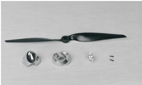
Montieren Sie die Luftschraube mit Konus und der Spinner-Rückwand. Lassen sie dabei einen Spalt von ca. 4mm zwischen der Sternmotor-Attrappe und der Spinner-Rückwand.
