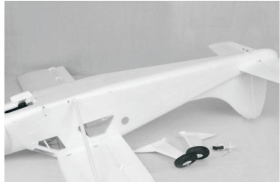
Entfernen sie das Hauptfahrwerk und das Heckrad vom Rumpf.
