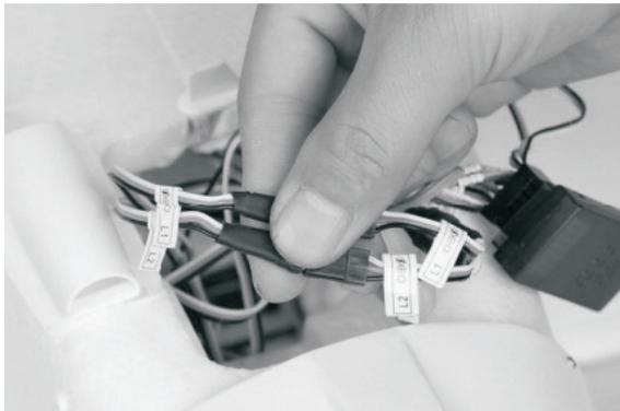
Ordnen Sie die Steurfunktionen des Empfängers an die entsprechenden Kanäle zu. Schließen Sie den Regler an und platzieren Sie den Empfänger. Verlegen sie gemäß des Fernsteuersystems die Litzenantenne(n).
