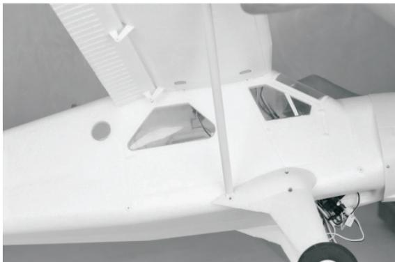
Führen Sie das Ende A an das Loch vom Fahrwerk. Anschliessend befestigen Sie diese mit Blehschrauben.
