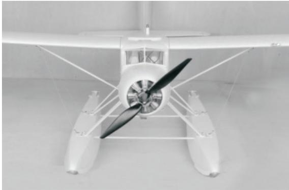
Gehen Sie sicher das die Streben auf beiden Seiten gleichlang sind. Sie können sie anpassen indem sie Knoten an den Streben befestigen.
