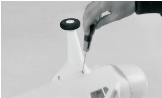
Montieren Sie die Fahrwerke auf beiden Seiten des Rumpfes mit sechs M3.0x16 Blechschrauben.
