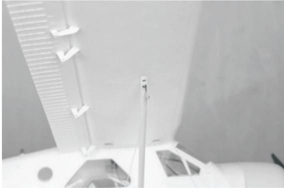
Verbinden Sie das mittlere Ende der Streben an den Flügelstreben und verbinden sie die anderen Enden der Streben mit den Schwimmern mit M2.5x8 Blechschrauben.
